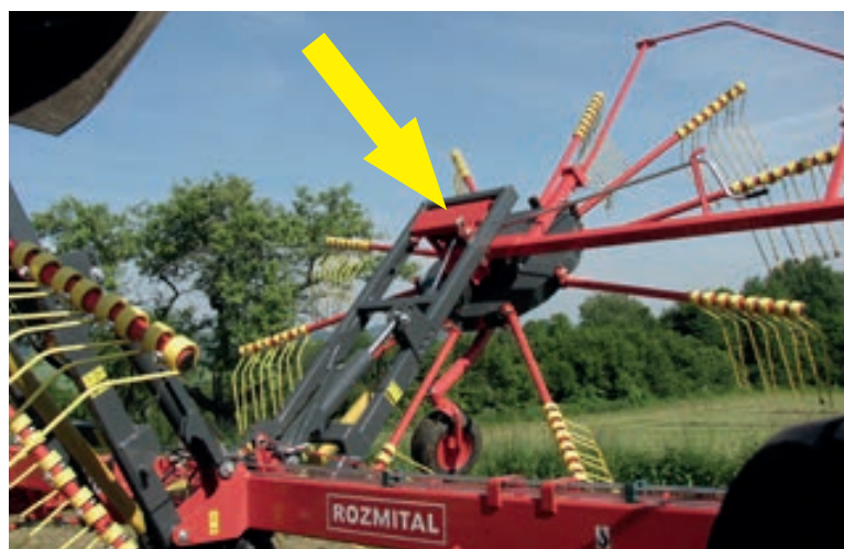
Automatický návrat rotorů do transportní polohy při sklopení ramen
