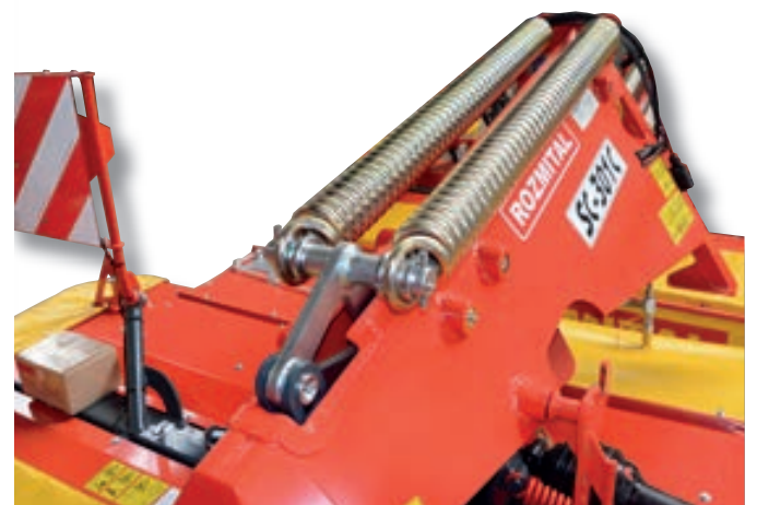
Nadlehčování lišty pomocí pružin.
