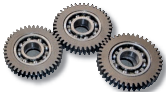
Ozubená kola lišty jsou vykovaná z ušlechtilé oceli a boky zubů jsou broušené. Šířka zubů je 22 mm u všech sekaček Rožmitál.
