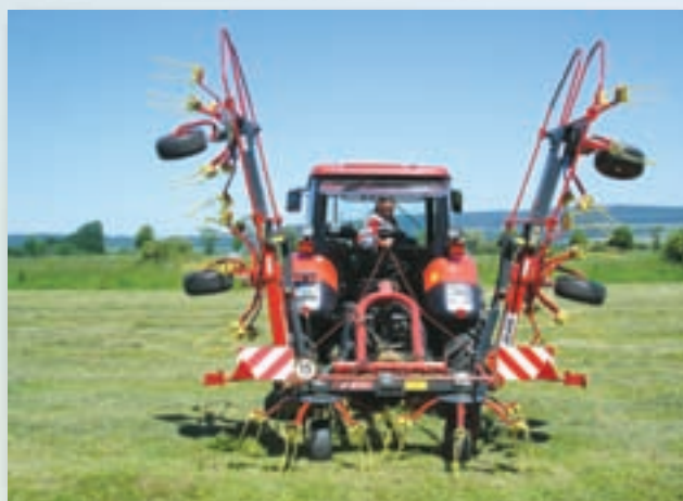
Rozkládání stroje - odjištění aretace.
