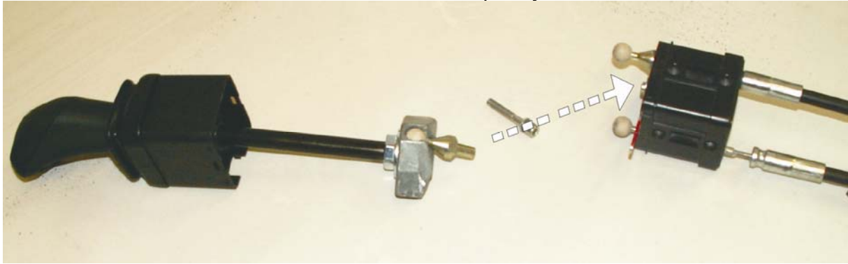
2.2 Zasunout do těla i pevný bod
