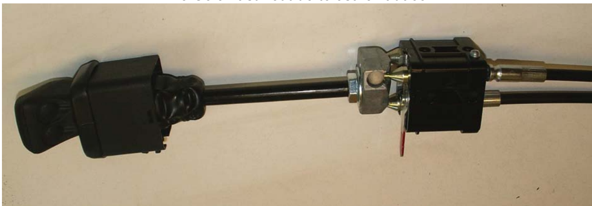
2.4 Zpět montovat imbus šroub M5 do tělesa (zalepit) 2.5 Bowdeny zajistit do drážky červíky
